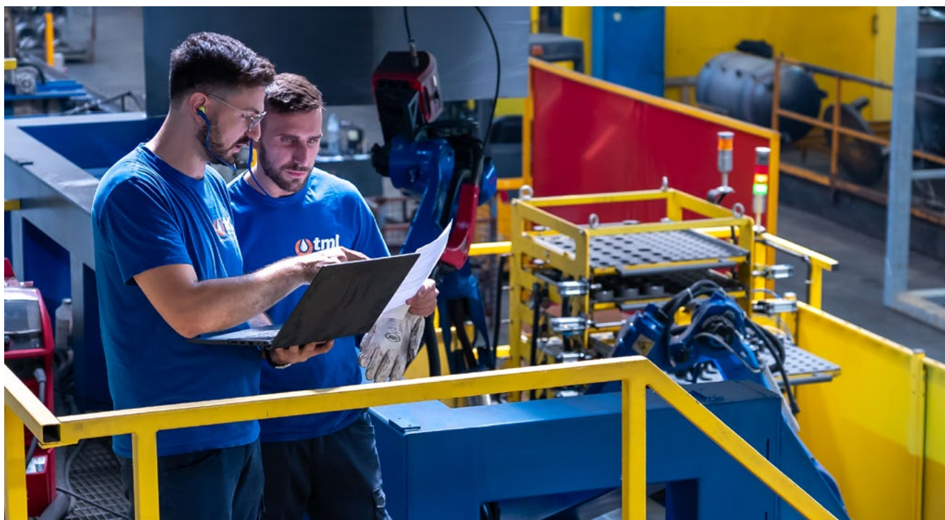
Settaggio parametri isola robotizzata di montaggio e saldatura manicotti su fasciame cilindrico.
