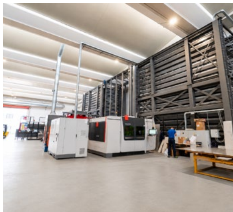
Impianto taglio laser con magazzino lamiere dedicato alla lavorazione di lamiere in acciaio inossidabile.
