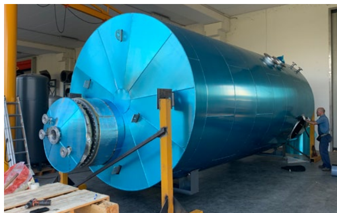
Accumolo in acciaio inox 40.000 lt.
