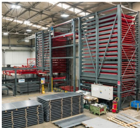
Impianto taglio laser con magazzino lamiere dedicato alla lavorazione di lamiere in acciaio al carbonio.
