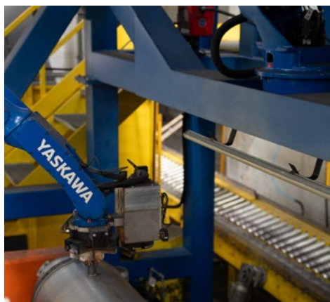
Montaggio robotizzato connessioni.
